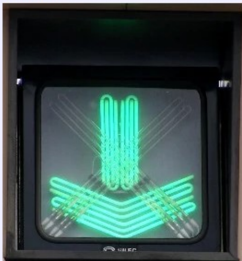
FAV à néons Silec en gare de péage sur l'A7.
