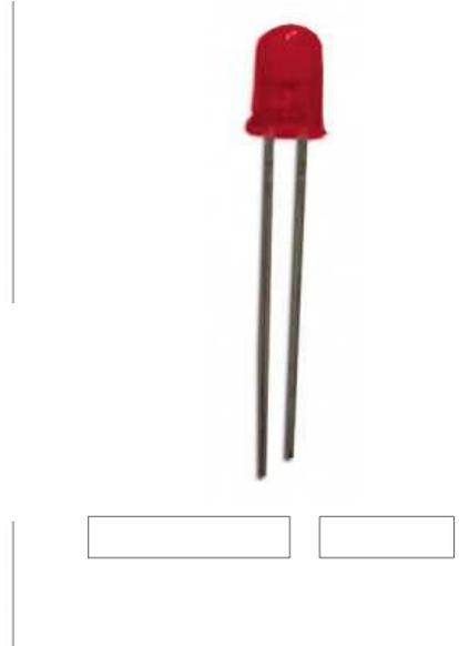
7°) Connecter la LED sur la plaque d'essai : RAPPEL SUR LED 13 PAS BESOIN DE RESISTANCE !
