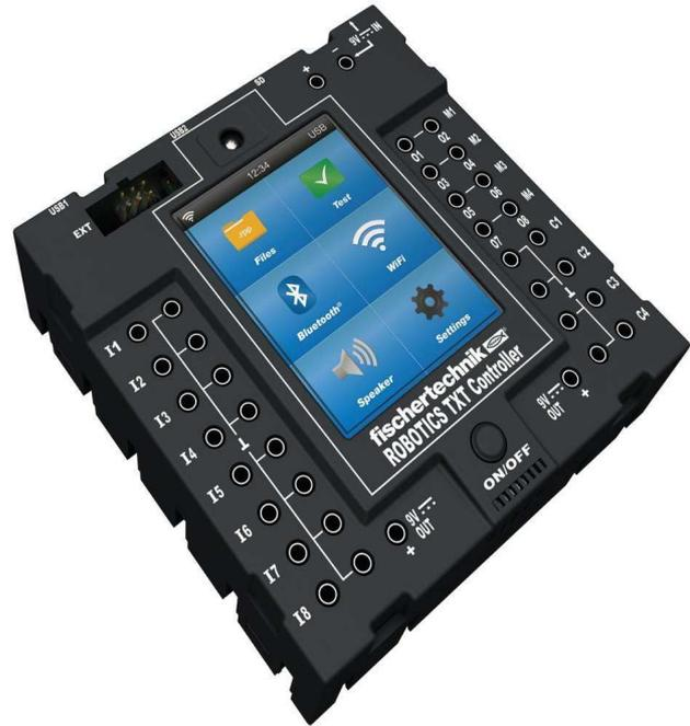
Cette interface est dotée d'un processeur 32 bits, d'un écran LCD, d'une capacité mémoire élevée et d'un boîtier compact (90 x 90 x 15 mm).
