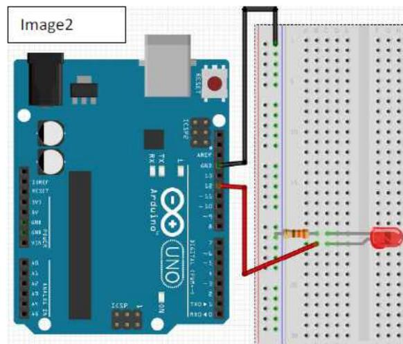
**ALGORITHME :** Allumer la del branchée sur la broche 12
