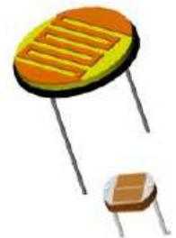
La photorésistance est un capteur analogique résistif.
