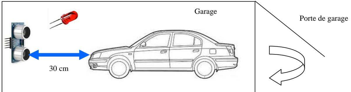
Quand la voiture arrive à 30 cm la led rouge placée en D13 s'allume, indiquant au conducteur qu'il est bien Garé et qu'il peut ainsi descendre sa porte de garage
