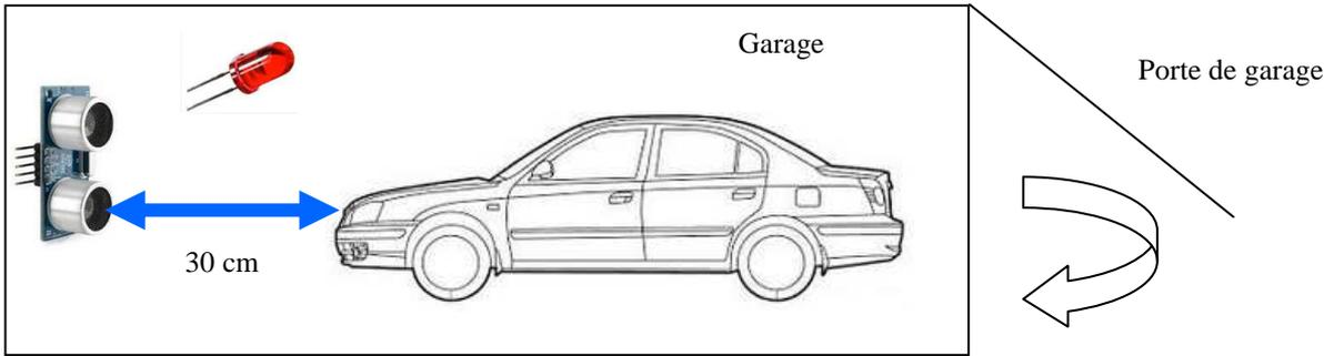
Quand la voiture arrive à 30 cm la led rouge placée en D13 s'allume, indiquant au conducteur qu'il est bien Garé et qu'il peut ainsi descendre sa porte de garage
